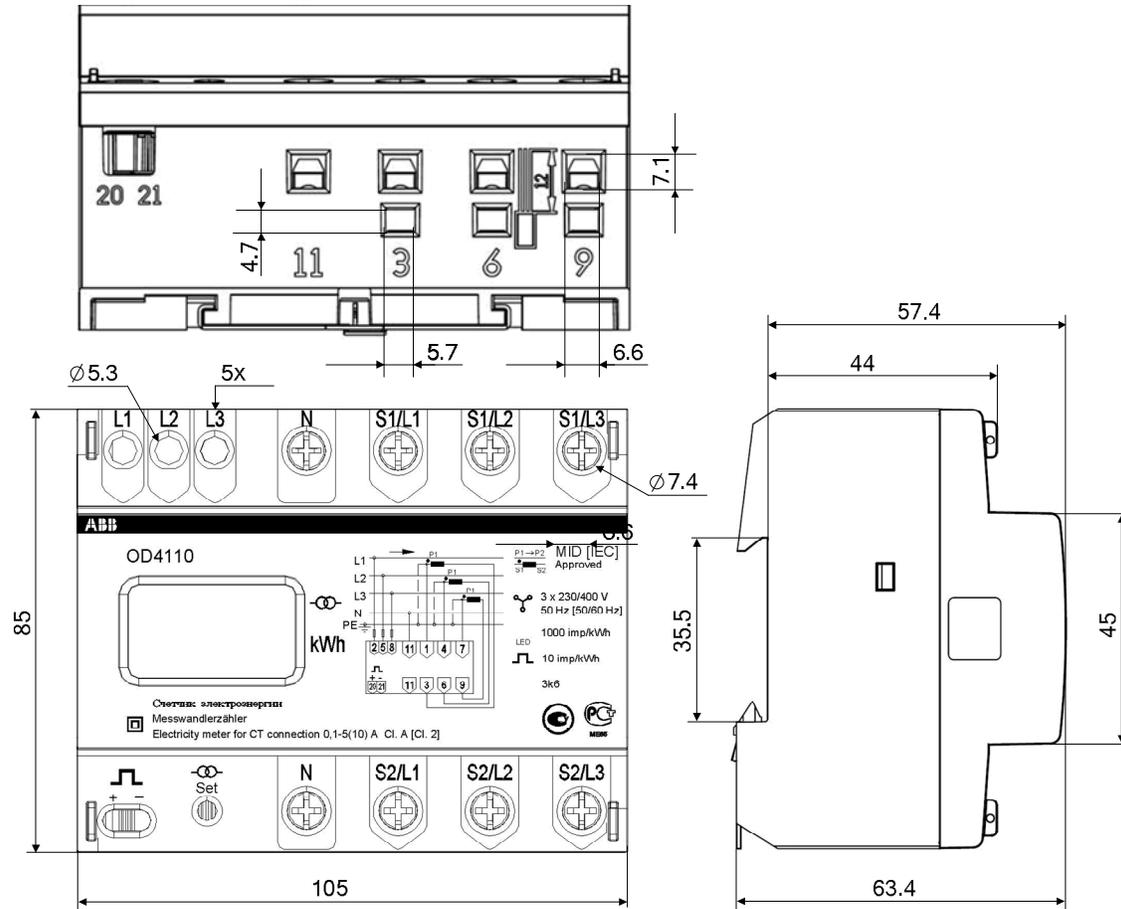
*Fig. 2-13 Meter dimensions*
